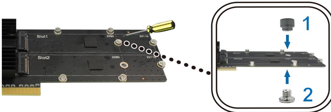
b Setzen Sie die SNV3400-400G in den Steckplatz ein. Achten Sie darauf, dass die Karte ganz eingesteckt ist.
