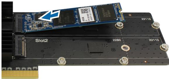
c Befestigen Sie die SNV3400-400G mit einer Schraube.
