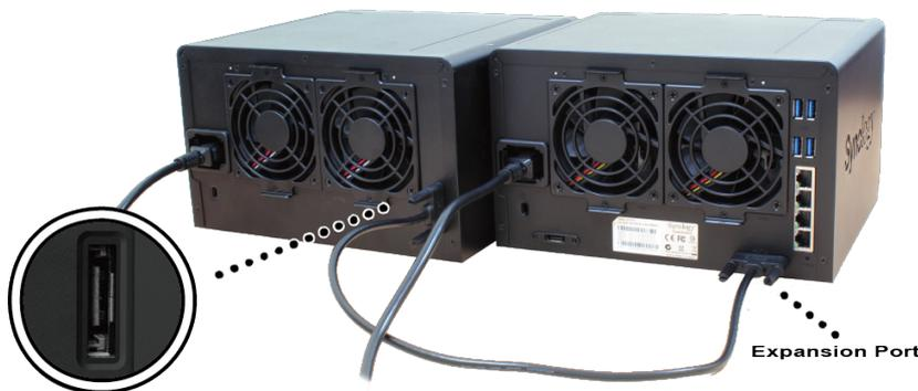
Wenn die Geräte verbunden sind, schaltet sich DX517 automatisch ein und aus, wenn die verbundene DiskStation herunter- oder hochfährt.
