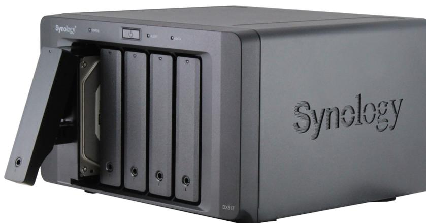
**Anmerkung:** Achten Sie darauf, dass der Einschub vollständig hineingeschoben ist. Ansonsten funktioniert das Laufwerk möglicherweise nicht korrekt.
