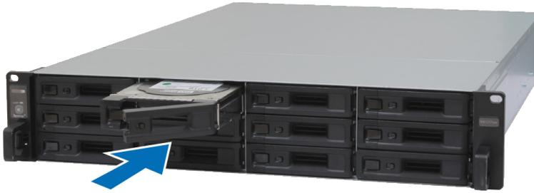
**Anmerkung:** Achten Sie darauf, dass der Einschub vollständig hineingeschoben ist. Ansonsten funktioniert das Laufwerk möglicherweise nicht korrekt.
