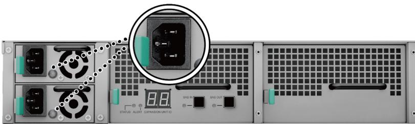
**Anmerkung:** Die RX1217sas ist mit einem redundanten Stromversorgungssystem ausgestattet, an das zwei Stromkabel angeschlossen werden können. Das System kann auch mit nur einem Stromkabel betrieben werden, wir empfehlen aus Gründen der Ausfallsicherheit allerdings die Verwendung von zwei Stromkabeln.
